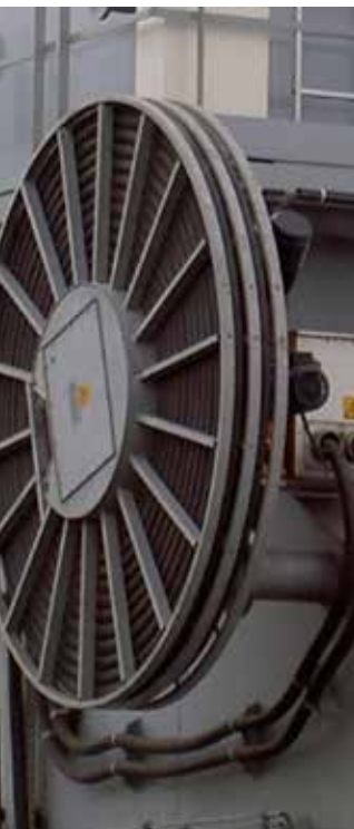
Bobina monoespiral doble, con dos cables idénticos de gran sección transversal.
