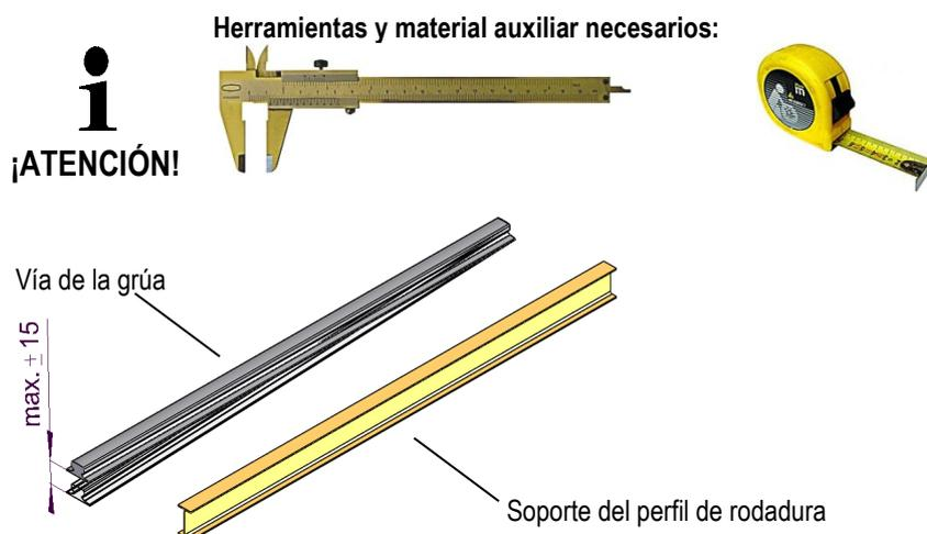
Fig. 8: Asimetría vertical entre vía de la grúa y el soporte del perfil de rodadura
