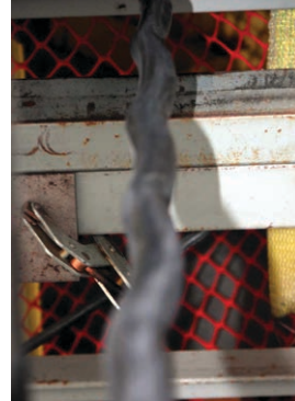
Cable que falla debido al efecto “tirabuzón”
