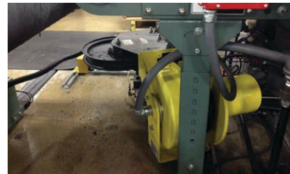
Cable que falla debido al efecto “tirabuzón”
